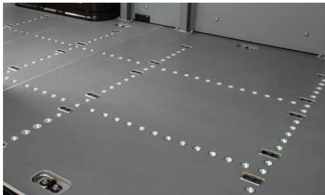
SAFETY CROSS: puntos de fijación longitudinales y transversales bajo pedido
